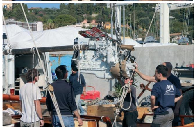
1. Le Santo Sospir. - 2. et 3. Dépose de l'ancien moteur. - 4. 5. et 6. Pose du nouveau moteur
