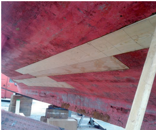
Côté bâbord ouvert puis refermé en moins d'une semaine !
